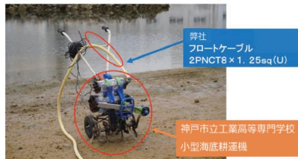
写真5 高等専門学校に提供している水中フロートケーブルの実証実験風景
