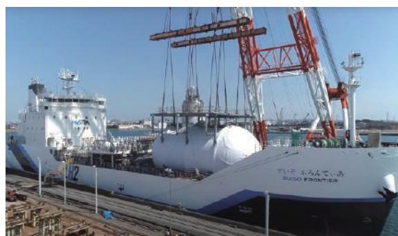
高断熱の荷役実現のため、真空構造の配管(真空二重配管、真空ジャケット付弁、バイヨネット接手)などを採用し、本船は完成した。2021年6月から、神戸空港島に建設した液化水素荷役実証ターミナル「Hy touch 神戸」にて約4ヶ月間の荷役オペレーションを検証した(図5)。9月には、液化水素満載による近海試験航海を行い、20日間以上の蓄圧性能を実証した(図6)。
