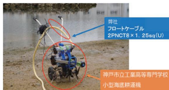
写真5 高等専門学校に提供している水中フロートケーブルの実証実験風景
