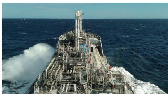
図6 液化水素満載による近海試験航海
