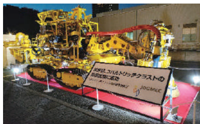
特別展示: コバルトリッチクラスト掘削試験機 (JOGMEC提供)
