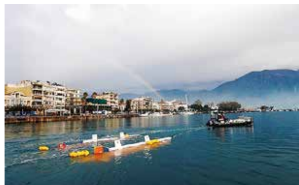
写真1 現地でのASVによるAUV2機曳航テスト
