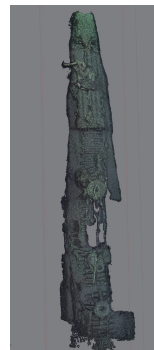
立ち上がる潜水艦伊47の艦橋前部の画像からの三次元再構成
