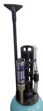
図1 アルゴフロート(MRV社製S3Aフロート)に取り付けた RINKO® FT
