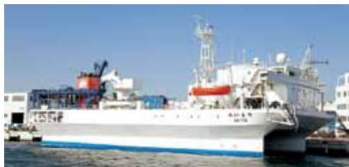
図2 海洋調査船「かいよう」(全長:61.4m、幅:28m、深さ:10.6m、国際総トン数:3,350t)
