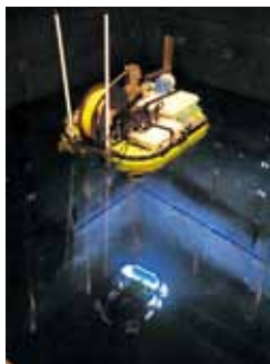
図2 調査ビークルによる壁面調査 (東京大学ロボット水槽)
