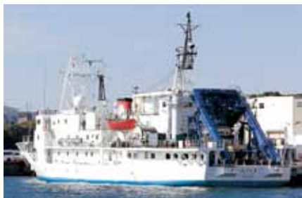
図1 海洋調査船「なつしま」(全長:67.4m、幅:13m、深さ:6.3m、国際総トン数:1,739t)
