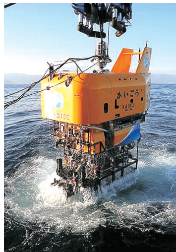
海底資源探査などを目的にピークル部分を新たに開発した無人探査機「かいこうMk-IV」
