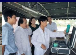
ハロン湾の客船を使ったBDF使用実験・排ガス測定
